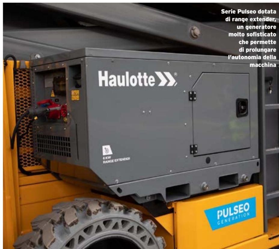
Serie Pulseo dotata di range extender, un generatore molto sofisticato che permette di prolungare l'autonomia della macchina
