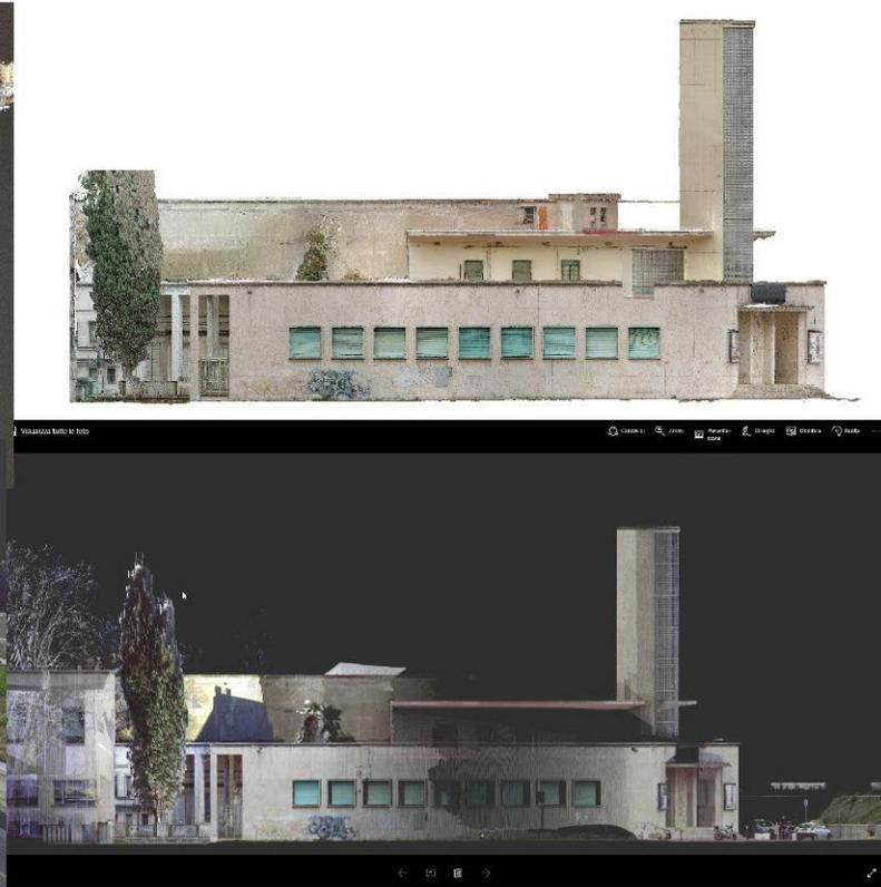
Rilievo al laser scanner 3D dell'intero sito di oltre 90.000 mq sommando la sola parte interna. Rilevando la zona in due squadre con due Faro abbiamo impiegato circa 12 giorni ed effettuate le elaborazioni nelle successive 3 settimane abbiamo restituito una nuvola di punti georeferenziata di un'area di oltre 9 ettari con un errore spalmato di soli 4 centimetri.
