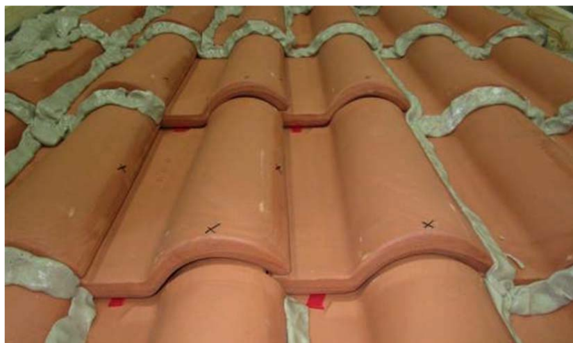
2. Box sperimentale. stelli e contro-listelli. Tutte le sovrapposizioni e le linee di accostamento fra le tegole sono state sigillate tranne una serie corrispondente alla sovrapposizione di quattro tegole. La portata era controllata da un ventilatore a velocità variabile e misurata utilizzando un anemometro EDRA6. Un manometro digitale consentiva la misurazione della differenza di pressione fra l'interno del
